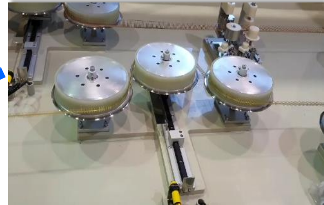
턴 구간 Tension조정 롤러 공정
